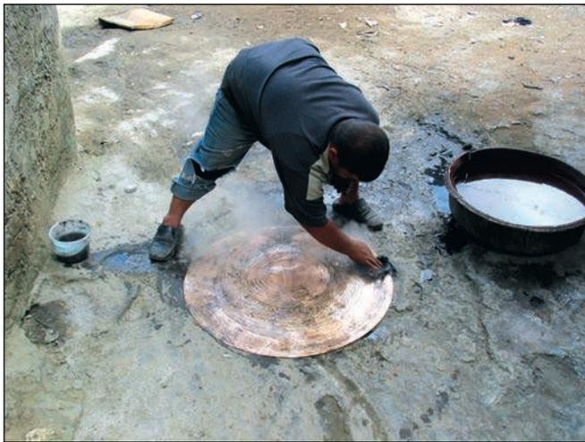
**Figure 21** (A1a.11) Nettoyage avec l'acide, contenu dans le récipient en plastique à gauche, dilué à l'eau (cuvette à droite).
