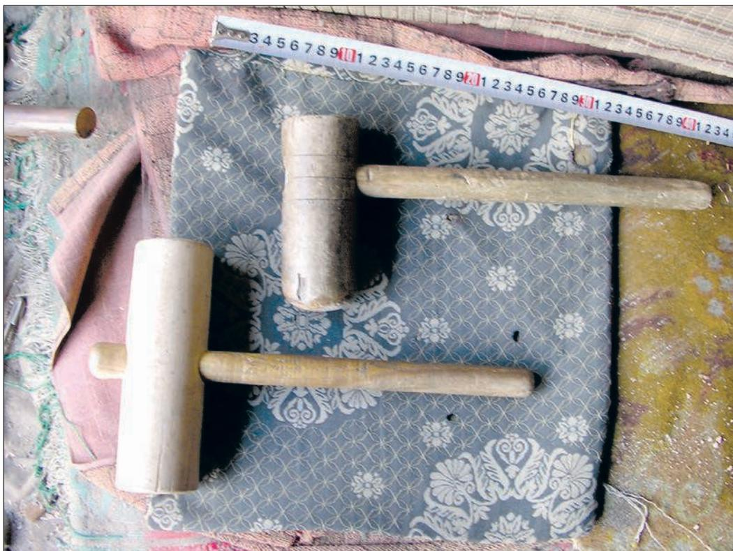
**Figure 50** (A2.6) Deux maillets (*de'ma' pl. de'ma'at*), à tête plate (en bas) et à tête bombée (*de'ma' mdawwar*) (en haut).
