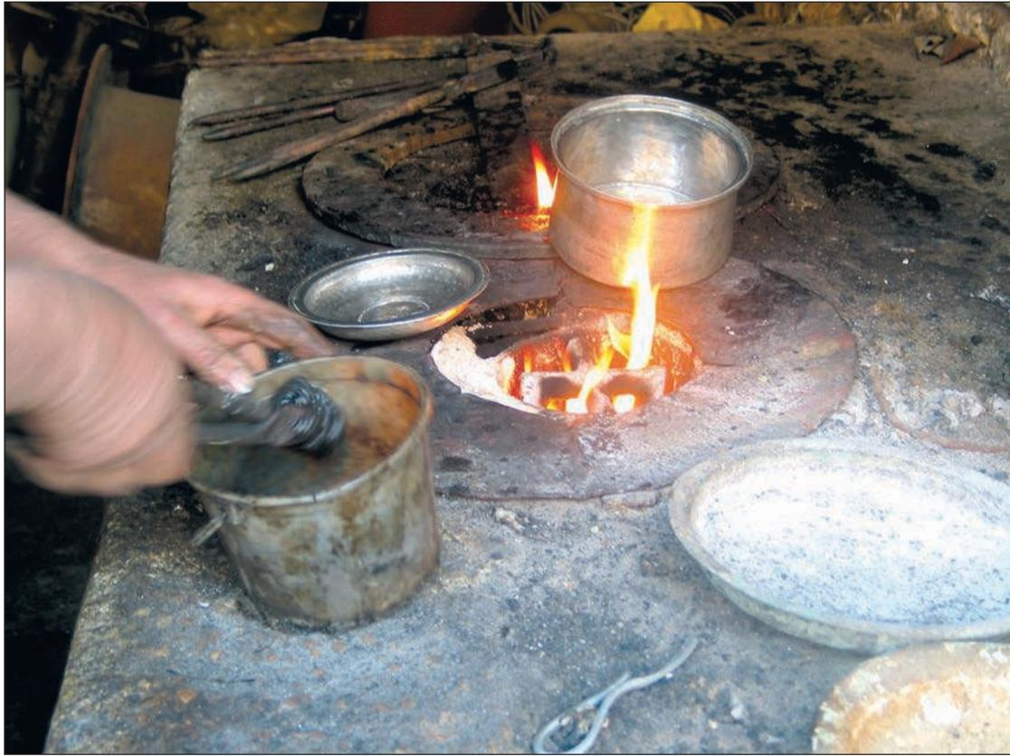
Figure 73 Premier nettoyage à l'acide d'un objet étamé.
