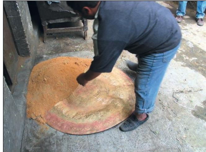
**Figure 23** (A1a.13) Nettoyage et polissage à la sciure (poste 8).
