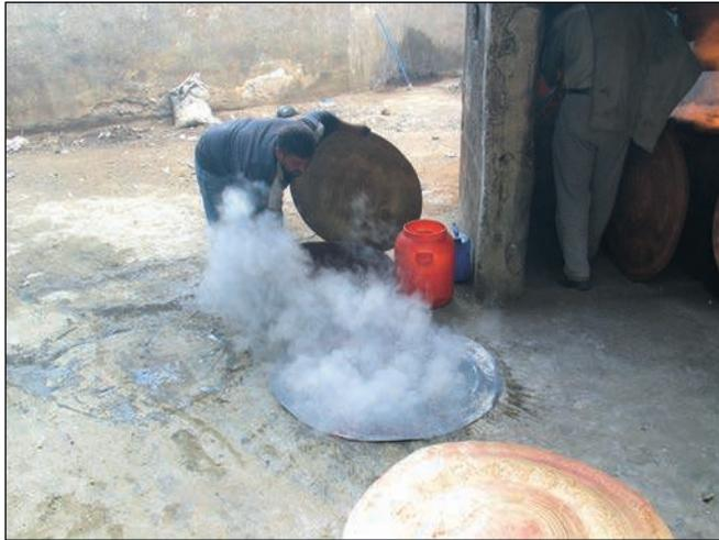
**Figure 20** (A1a.10) Le plateau est refroidi par aspersion d'eau froide, par un ouvrier.
