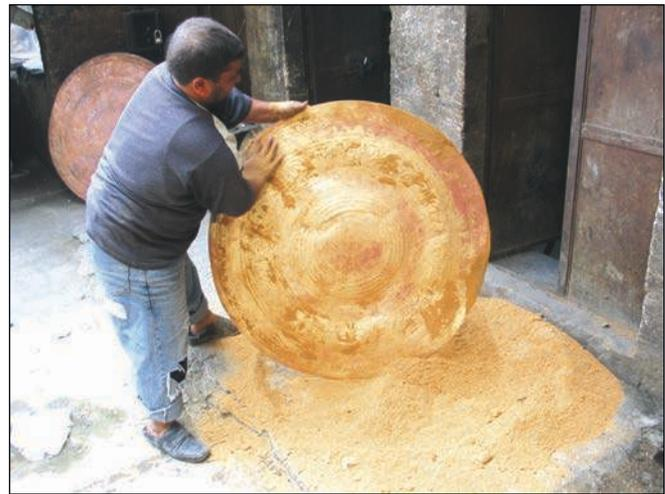
**Figure 24** (A1a.14) Nettoyage et polissage à la sciure (poste 8).
