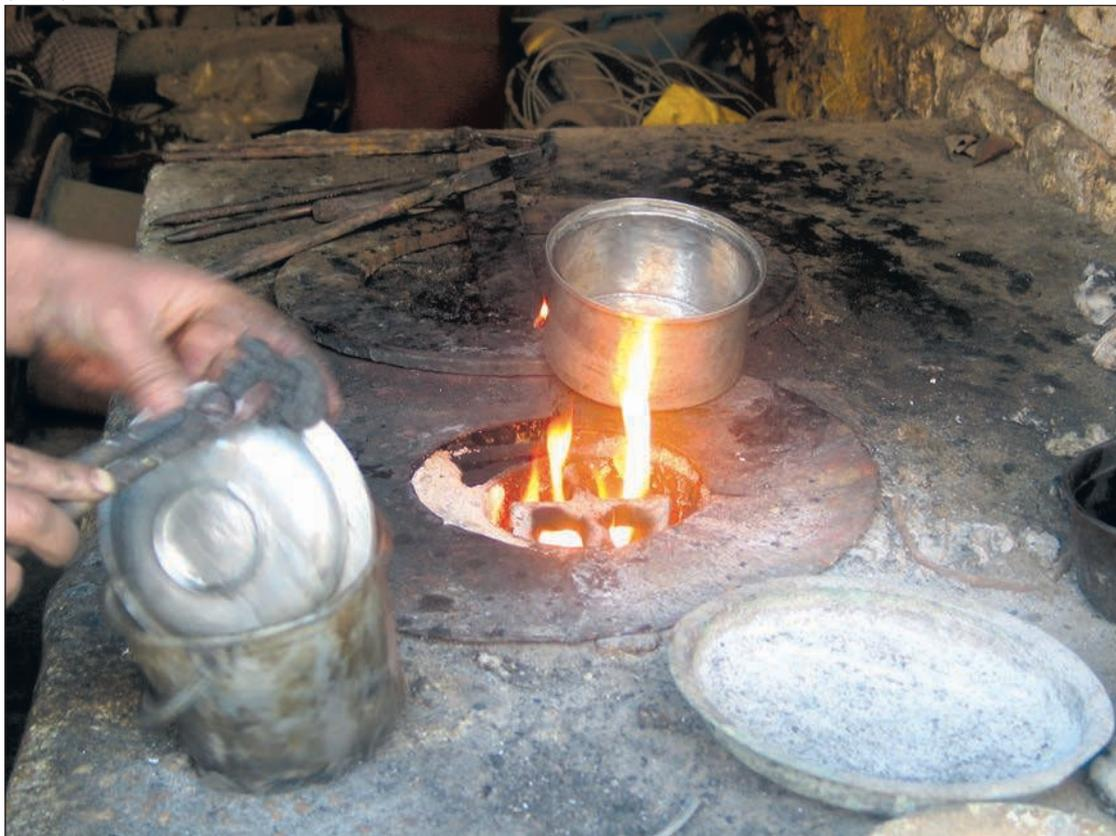
Figure 74 Premier nettoyage à l'acide d'un objet étamé.
