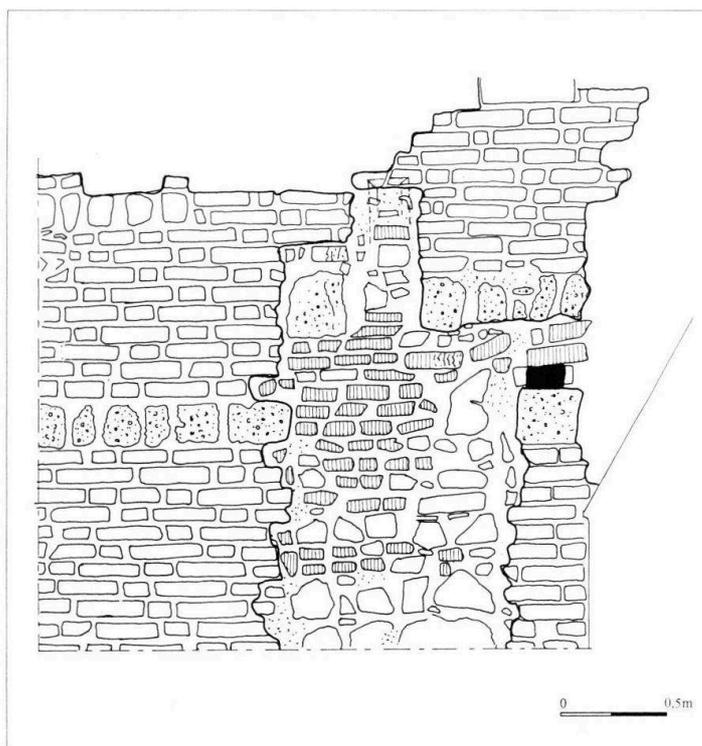
Remarquer les assises en appareil régulier de tuf alternant avec celles de la maçonnerie de briques. Les proportions de la fente de jour, très altérée sur le parement externe de la tourelle, sont indiquées par la brique qui formait linteau, sur laquelle le chanfrein de l'encadrement a été obtenu par retaille
